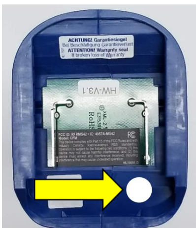
Abbildung 2 – Überprüfen Sie ob sich im Batterieschacht ein weißer Punkt befindet. Sollte ein weißer Punkt vorhanden sein, ist das Werkzeug nicht betroffen.
