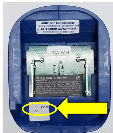
Abbildung 3 – Bestimmen Sie das zweistellige Werkzeugdatum. (Kreis zeigt in diesem Beispiel "QS" an)
